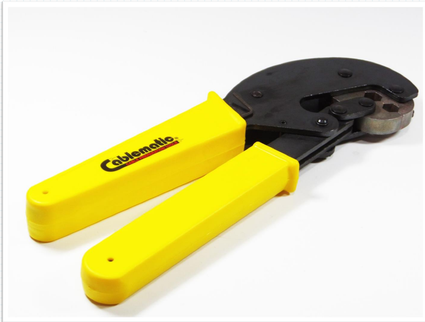
Ferramenta de crimpar conectores F tipo "hexagonal / sextavado"
